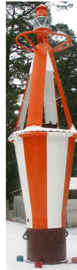
Рис. 13. Буй пластмассовый средний БПС—73 1 — светооптический аппарат; 2 — световой датчик; 3 — ограждающее кольцо; 4 — радиолокационный пассивный отражатель; 5 — надстройка; 6 — люк; 7 — привальный брус; 8 — корпус буй; 9 — рым якорный; 10 — пояс заземления; 11 — балласт противовеса; 12 — контейнеры; 13 — внутренний конус; 14 — наружный конус; 15 — проблесковый аппарат
